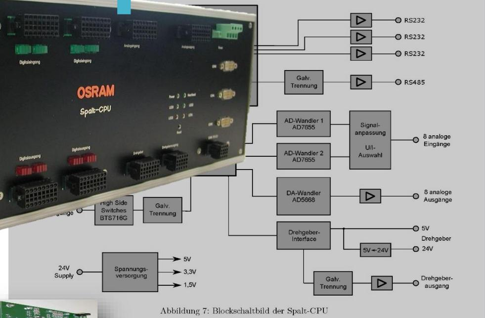
Abbildung 7: Blockschaltbild der Spalt-CPU
