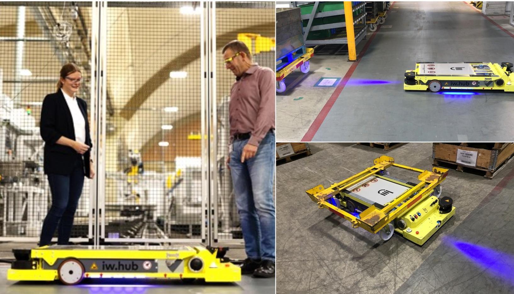
FTS-Projekt zum Transport von Spänebehältern und Entsorgungsbehältern
